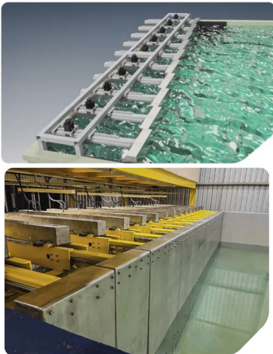
Figura 4: Idealização inicial de batedores tipo pistão com cremalheira e foto dos batedores instalados (Paludo et al., 2025)
